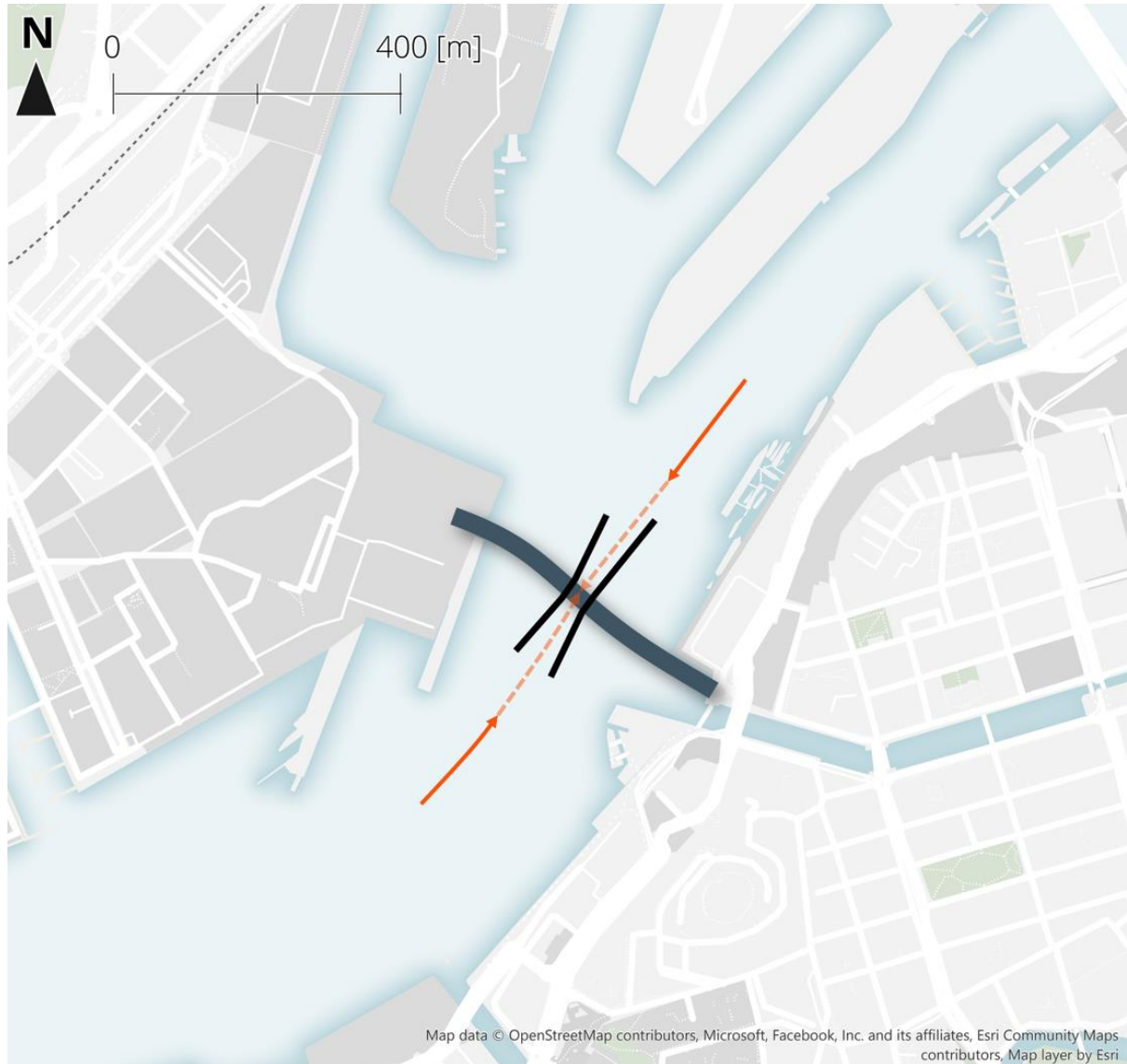
Figur 11. Kritisk sträcka "s" där ett mänskligt fel eller roderfel leder till att ett fartyg kan segla på bron eller dess ledverk. Sträckan beror på fartygens färdriktning (se pilriktning). För såväl uppströmsgående som nedströmsgående fartyg beaktas en sträcka om 0,2 nautiska mil (375 m) före passage och fram till bron. Om det uppstår ett roderfel eller mänskligt fel bortom denna sträcka är det få vinklar där kursavvikelsen innebär att fartyget kommer att avvika i en riktning som leder till påsegling av bron, och besättningen har mer tid att reagera och korrigera kursen innan det leder till en påsegling av bron. Senare i analysen motiveras att det endast är längs sträckorna markerade med heldragna pilar som roderfel kan leda till skada på brobanan (se avsnitt 5.2.2).
