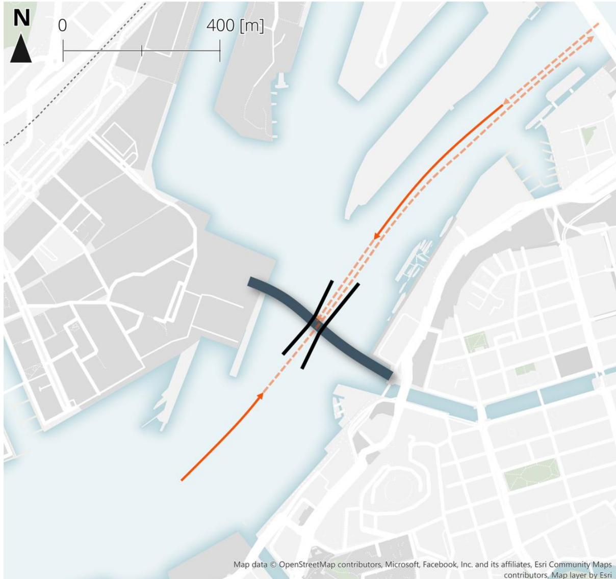
Figur 10. Kritisk sträcka "s" där ett fartyg som börjar driva kan driva in i bron eller dess ledverk. Sträckan beror på fartygens färdriktning (se pilriktning). För uppströmsgående fartyg beaktas en sträcka om 1 500 meter som börjar efter Halvön på Masthuggskajen och fortsätter upp till Hisingsbron. För nedströmsgående fartyg beaktas en sträcka om 1 000 meter från Hisingsbron och fram till gång- och cykelbron. Senare i analysen motiveras att det endast är längs sträckorna markerade med heldragna pilar som maskinhaveri kan leda till skada på brobanan (se Tabell 14).
